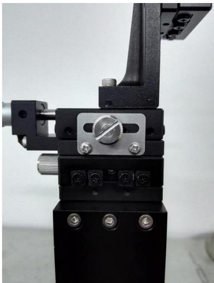
图8 手动三维位移平台初始状态
