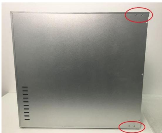
图 6 数据采集系统侧面板固定螺丝
