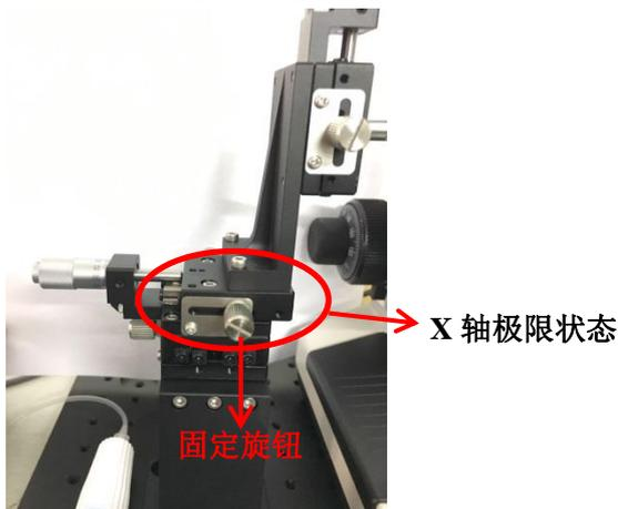
图 12 手动三维位移平台
