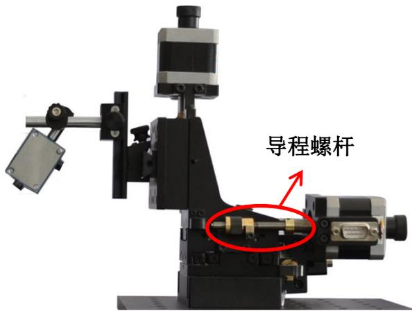
图 1 电动三维位移平台
