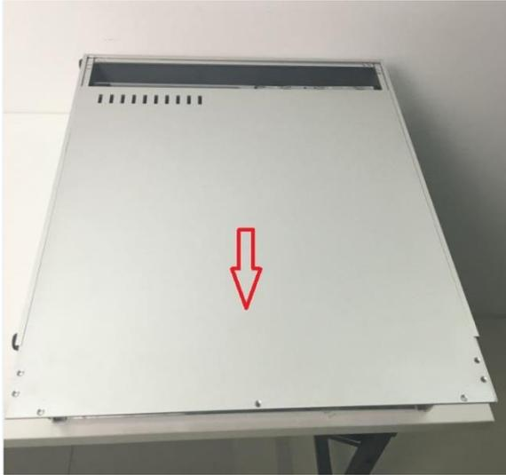
图7 拆卸侧面板
