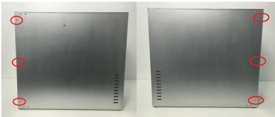
图 5 数据采集系统后面板固定螺丝
